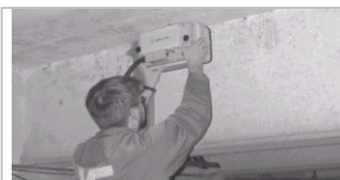
Radarmätning på en brobalk för att kartlägga armering och spännkablar.
