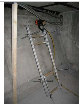
Vänster: Bro med efterspänd betong. Innan borring i balksidorna skall spännkablarnas lägen kartläggas med röntgen. Mitten: röntgenplåten monteras på utsidan. Höger: isotopen monterad på insidan.
