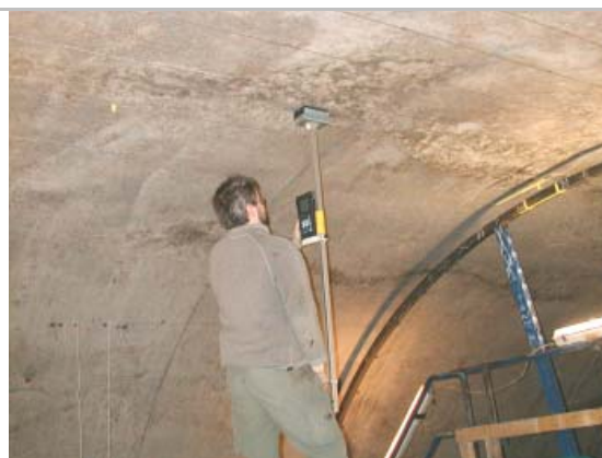
Vänster: Denna tunnel har en 600 mm tjock betongmantel som platsgjutits. Höger: Betongens tjocklek och homogenitet kontrolleras med ultraljudmätning.
